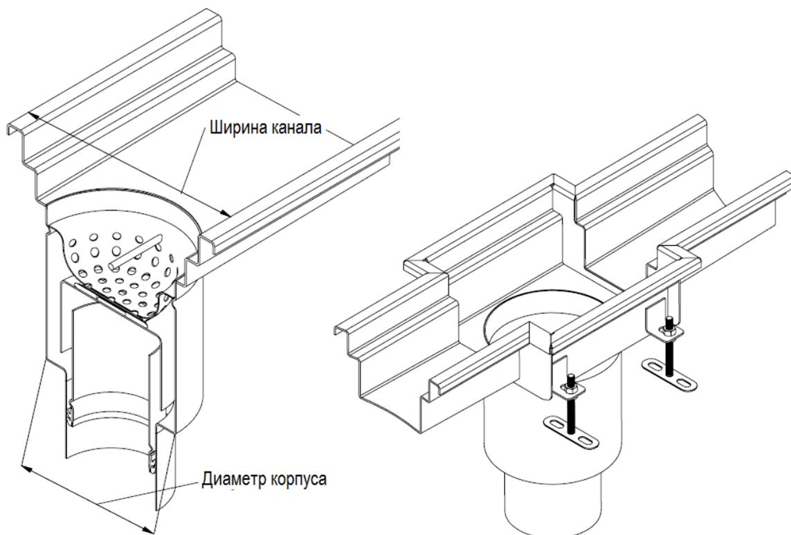
В зависимости от типа выпуска в таблице ниже приводятся стандартные размеры щелевых насадок для водоотводного канала.
