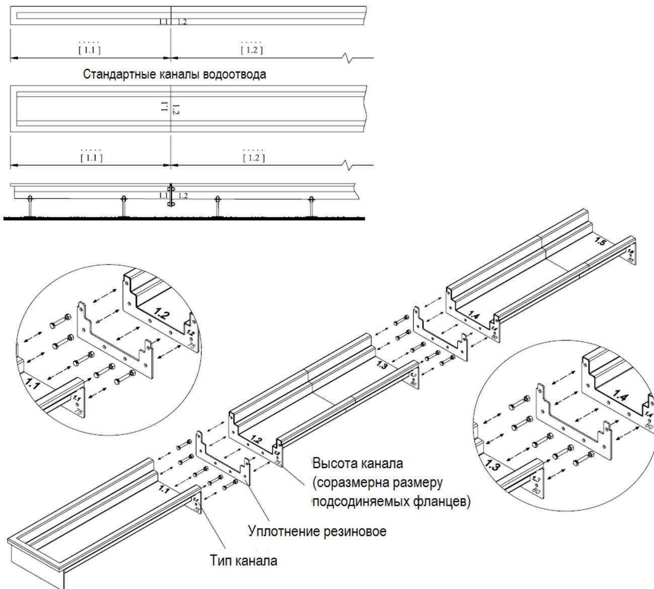
Для удобства транспортировки каналы для отвода воды состоят из секций, в стандартном исполнении их длина не превышает 4-6 м.
