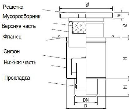
Для снятия плотно прилегающей решетки используется присоска. Вакуумная присоска представляет собой дополнительный элемент конструкции, она не поставляется в качестве части трапа.
