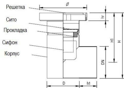
Для снятия плотно прилегающей решетки используется присоска. Вакуумная присоска представляет собой дополнительный элемент конструкции, она не поставляется в качестве части трапа.
